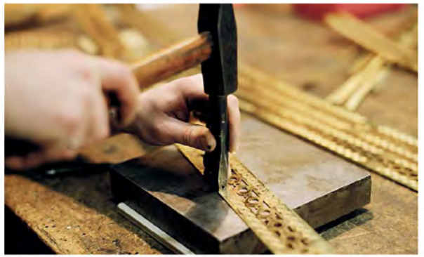
Die einzelnen Bronzeelemente der Luster werden mit dem Hammer bearbeitet, um ein filigranes Muster zu erzeugen
