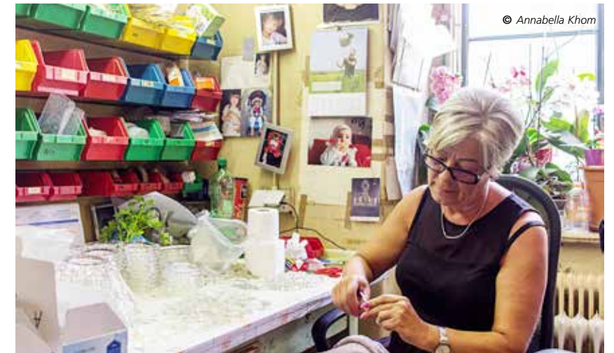
Das Lusterkleid aus unzähligen Glaskristallen wird seit jeher von Hand gekettelt. Dabei werden die Kristallelemente mit Drähten verbunden und zu einem vollständigen Behang zusammengefügt.
