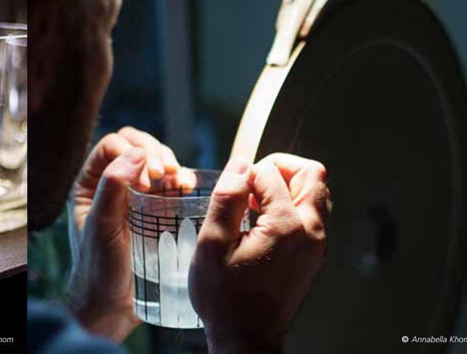
Vor dem Schleifen werden zur Orientierung Linien mit schwarzem Filzstift auf das Glas gezeichnet.
